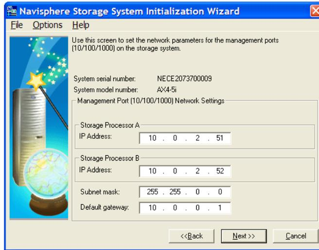
AX4 관리 포트의 IP 주소를 설정하고 나면, 4개의 iSCSI 데이터 포트에 대한 IP 주소 및 기타 네트워크 구성 매개변수를 입력해야 한다.
