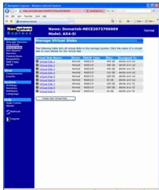
ディスク・プールの拡張も、容易に無停止で実行できます。この作業は、仮想ディスクの拡張作業と似ています。この例では、元々4台のディスク・ドライブで構成された新しい RAID-5 ディスク・プールを使用し、このプールに 2 個目のエンクロージャからさらに 3 台のドライブを追加して、プールを拡張しました。
