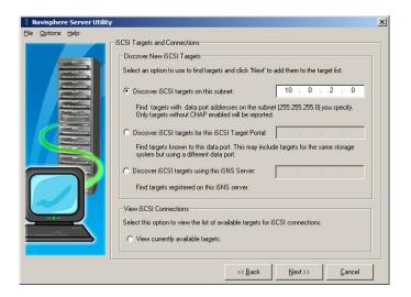
El paso Destino y conexiones iSCSI descubre todo el almacenamiento de información iSCSI visible para el host. Cuando se llevó a cabo esta instalación, solamente estaba visible el almacenamiento de información iSCSI AX4 para los tres servidores host.
