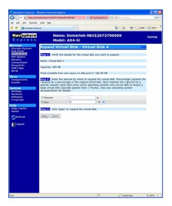
Durante unos minutos, mientras se expande el disco virtual, se muestra el estado. Una vez que finaliza la expansión, el host puede utilizar comandos estándares para expandir el volumen en espacio nuevo. En el entorno Windows, este paso se realiza mediante el comando "DISKPART".
