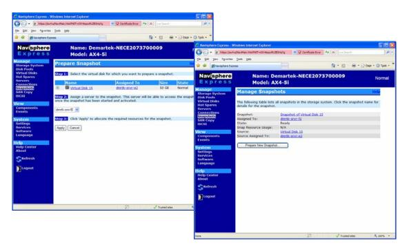
A continuación, se utiliza Navisphere Server Utility en los hosts para preparar la instantánea en el primer servidor y permitir el acceso a éste desde un segundo servidor.
