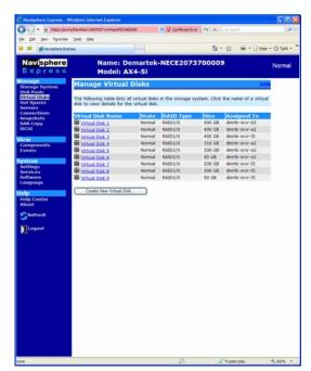
Los pools de discos también pueden expandirse con facilidad y de manera no disruptiva. El proceso es similar al proceso de expansión de discos virtuales. En este ejemplo, comenzamos con un pool de discos RAID-5 nuevo que originalmente estaba configurado con cuatro
