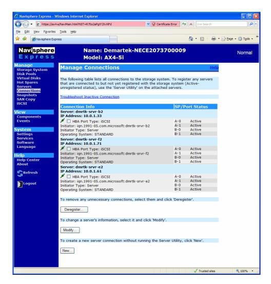
Se pueden configurar hasta 128 iniciadores iSCSI (64 hosts de alta disponibilidad). Pueden ser hosts físicos o hosts de un entorno de servidor virtual, como VMware<sup>®</sup>.
