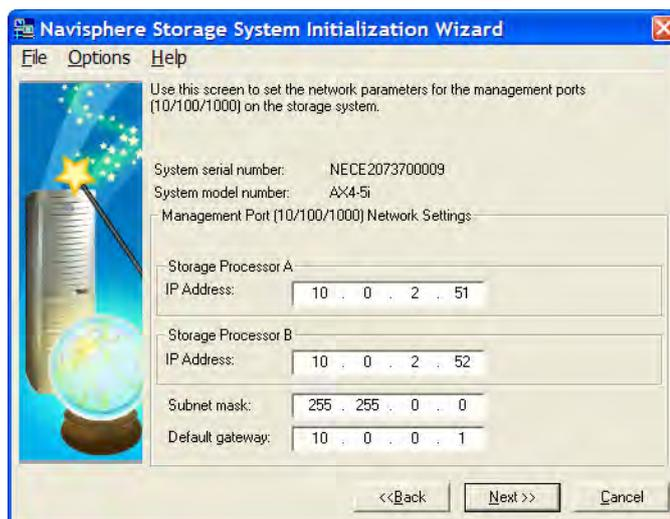
Wenn die IP-Adressen für die AX4 Management Ports eingerichtet wurden, müssen die IP-Adressen sowie weitere Netzwerkkonfigurationsparameter für die vier iSCSI-Datenports festgelegt werden.
